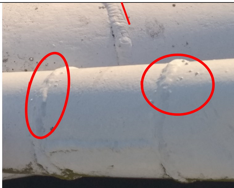
Obr. 31: Detaily povrchových vad svarů
